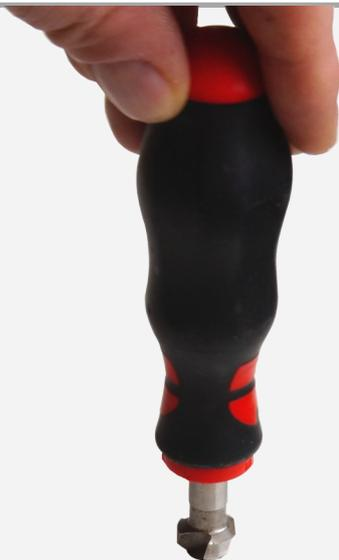
Bohrungen entgraten und gegen Korrosion schützen.
